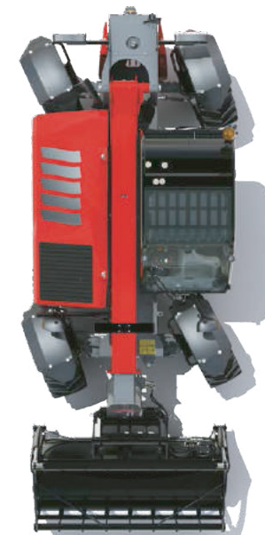
Крабовий хід – для більш ефективної роботи в обмеженому просторі
