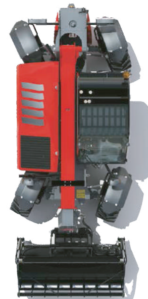
Управління усіма колесами – для мінімального радіусу повороту
